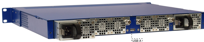
Рис. 5.2. Задняя панель коммутатора Metrotek X10-24
