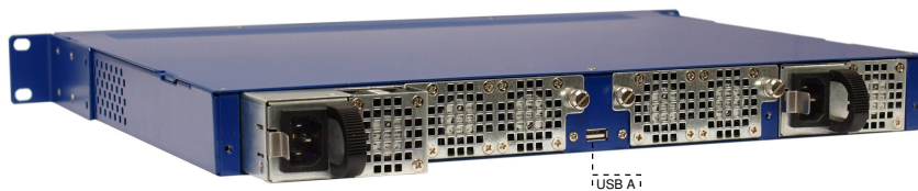
Рис. 5.2. Задняя панель коммутатора Metrotek X10-24
