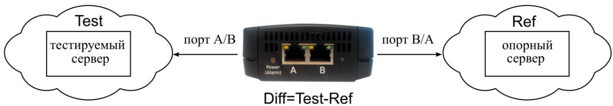
Рисунок 6.2. Типовая схема подключения для режима PTP
