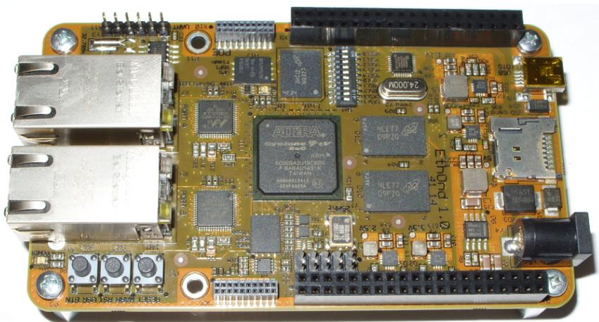
*Рис. 2.1. Внешний вид отладочной платы Metrotek EthOnd*
