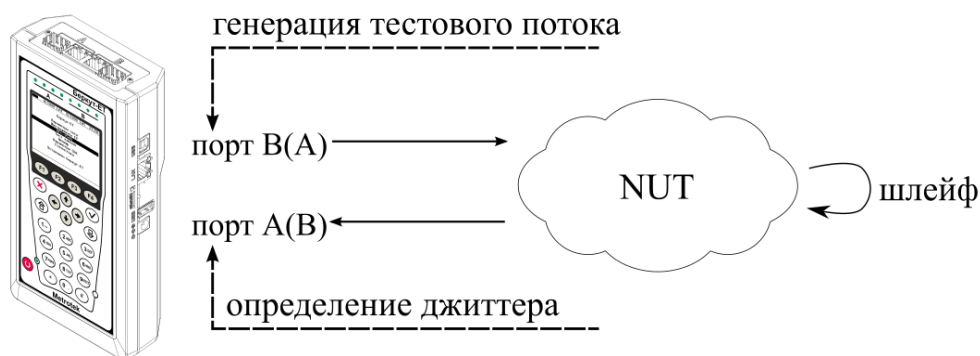
Рисунок 10.31. Измерение джиттера. Схема 2
