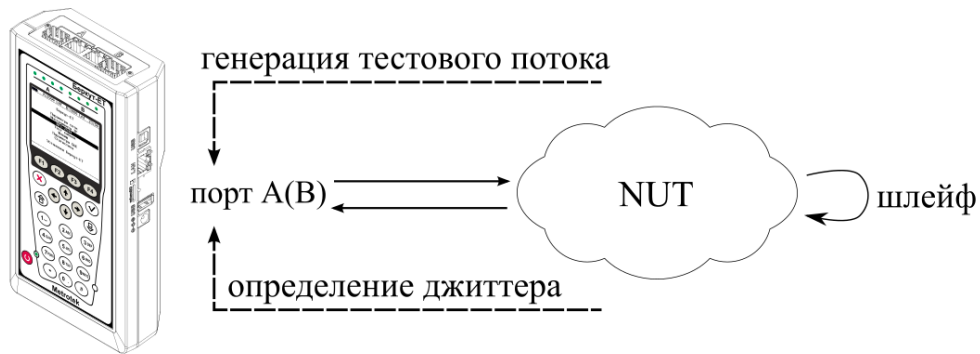
Рисунок 10.30. Измерение джиттера. Схема 1
