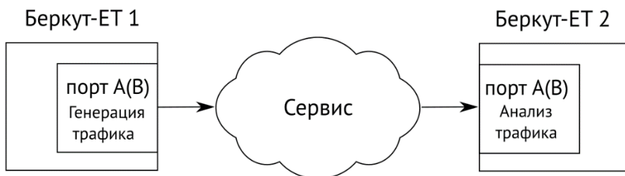
Рисунок 10.37. Схема включения с использованием двух приборов
