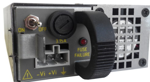
Рис. 6.3. Вид элементов управления БП и розетки питания
