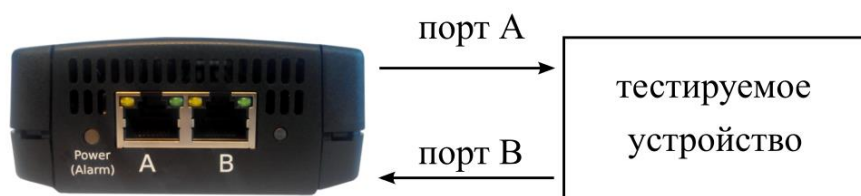
Рисунок 18.1. Типовая схема подключения для проведения теста «Тестовые данные»
