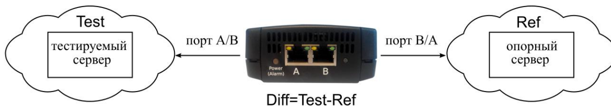
Рисунок 17.2. Типовая схема подключения для режима RTP
