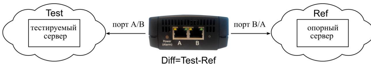
Рисунок 17.2. Типовая схема подключения для режима RTP
