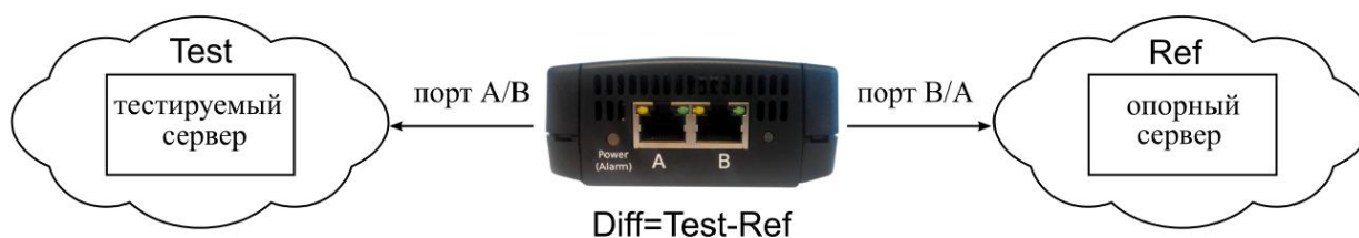
Рисунок 20.2. Типовая схема подключения для режима PTP
