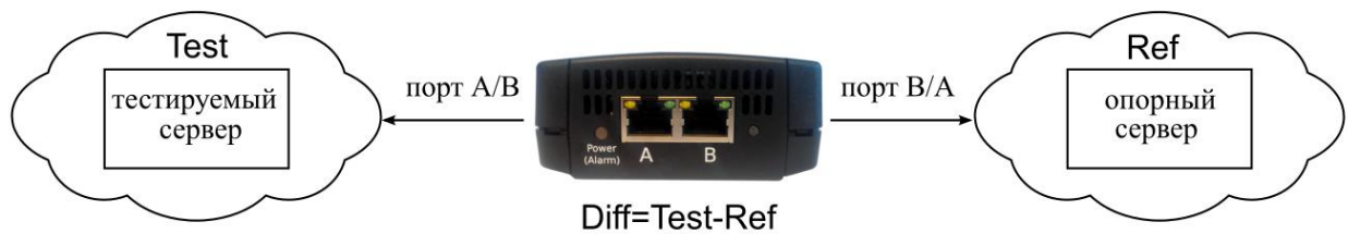
Рисунок 6.2. Типовая схема подключения для режима PTP
