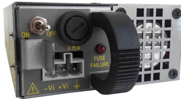
Рисунок 4.3. Вид элементов управления БП и розетки питания
