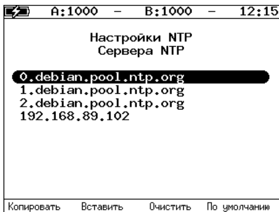
Рисунок 15.19. Настройка параметров синхронизации NTP. Добавление стороннего сервера
