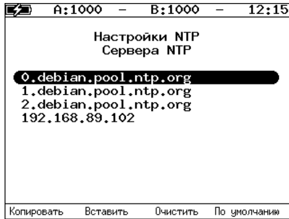
Рисунок 15.19. Настройка параметров синхронизации NTP. Добавление стороннего сервера
