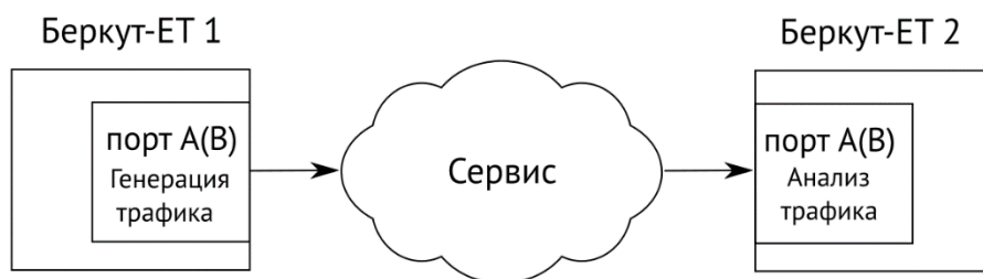
Рисунок 10.37. Схема включения с использованием двух приборов
