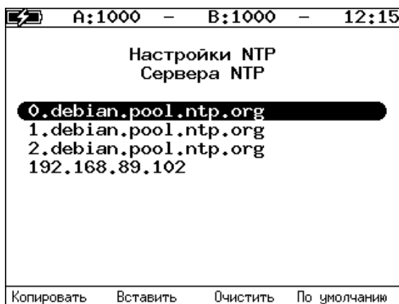
Рисунок 36.4. Настройка параметров синхронизации NTP. Добавление стороннего сервера
