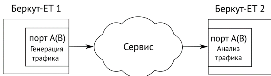
Рисунок 18.2. Схема включения с использованием двух приборов
