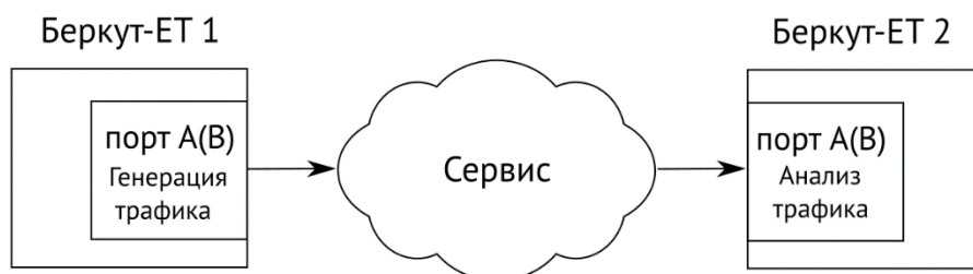
Рисунок 4.37. Схема включения с использованием двух приборов
