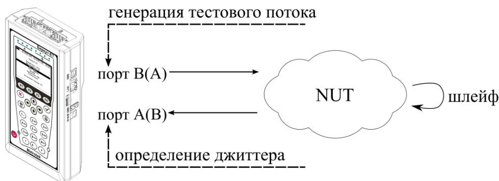
Рисунок 4.31. Измерение джиттера. Схема 2
