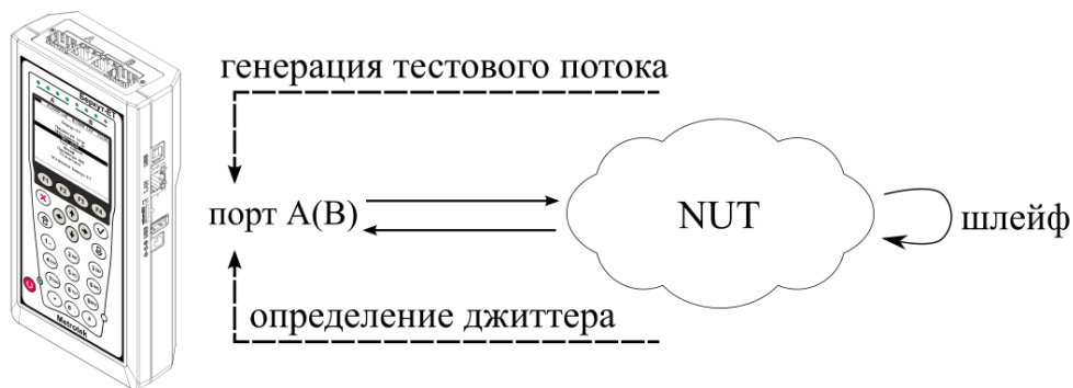
Рисунок 4.30. Измерение джиттера. Схема 1
