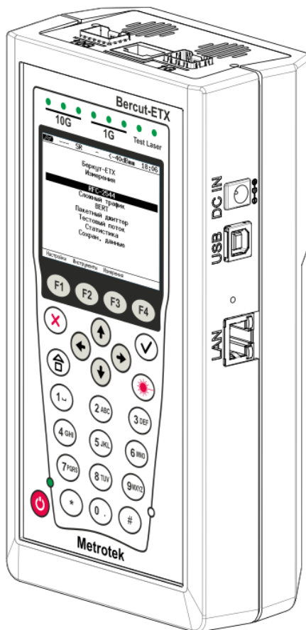
Рисунок 1.1. Внешний вид тестера-анализатора Беркут-ЕТХ
