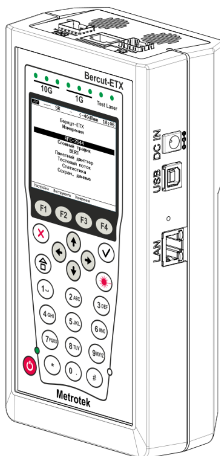
Рисунок 1.1. Внешний вид тестера-анализатора Беркут-ЕТХ
