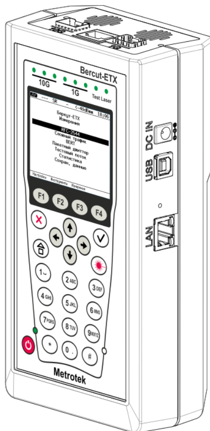
Рисунок 1.1. Внешний вид тестера-анализатора Беркут-ЕТХ
