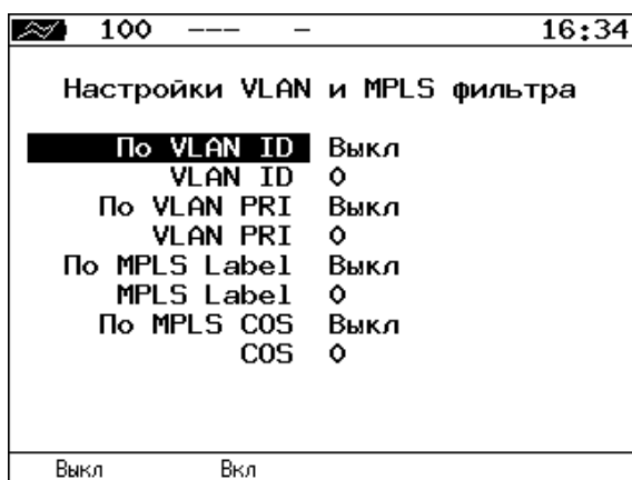
Рисунок 8.13. Меню «Настройки VLAN и MPLS фильтра»
