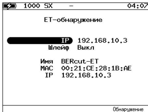
Рисунок 8.19. Пример выполнения ET-обнаружения
