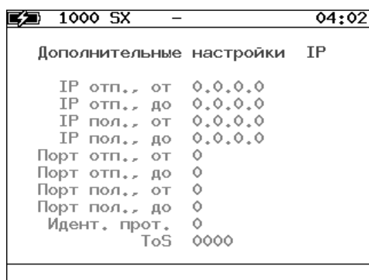
Рисунок 8.15. Меню «Дополнительные настройки IP»
