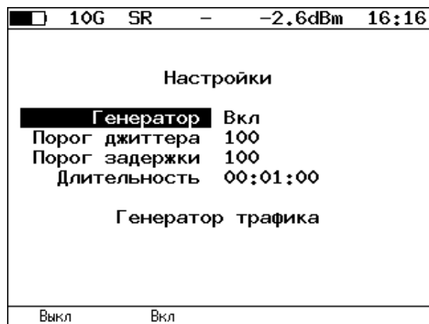
Рисунок 9.70. Меню «Пакетный джиттер. Настройки»
