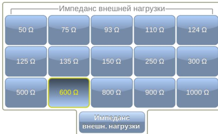
Рисунок 8.4. Выбор значения внешней нагрузки
