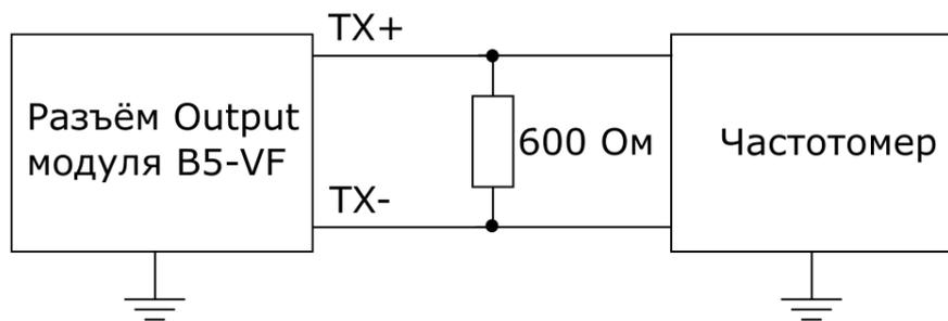
Рисунок 10.1. Схема подключения
