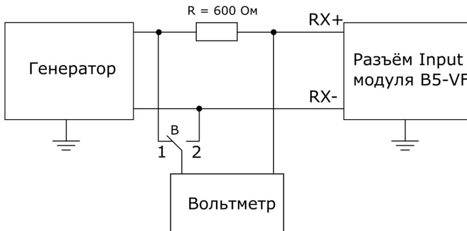
Рисунок 10.6. Схема подключения
