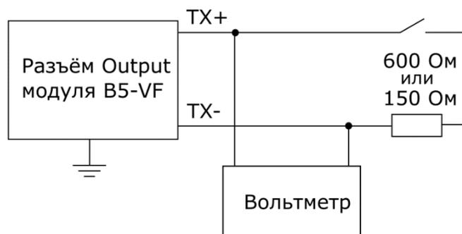
Рисунок 10.3. Схема подключения
