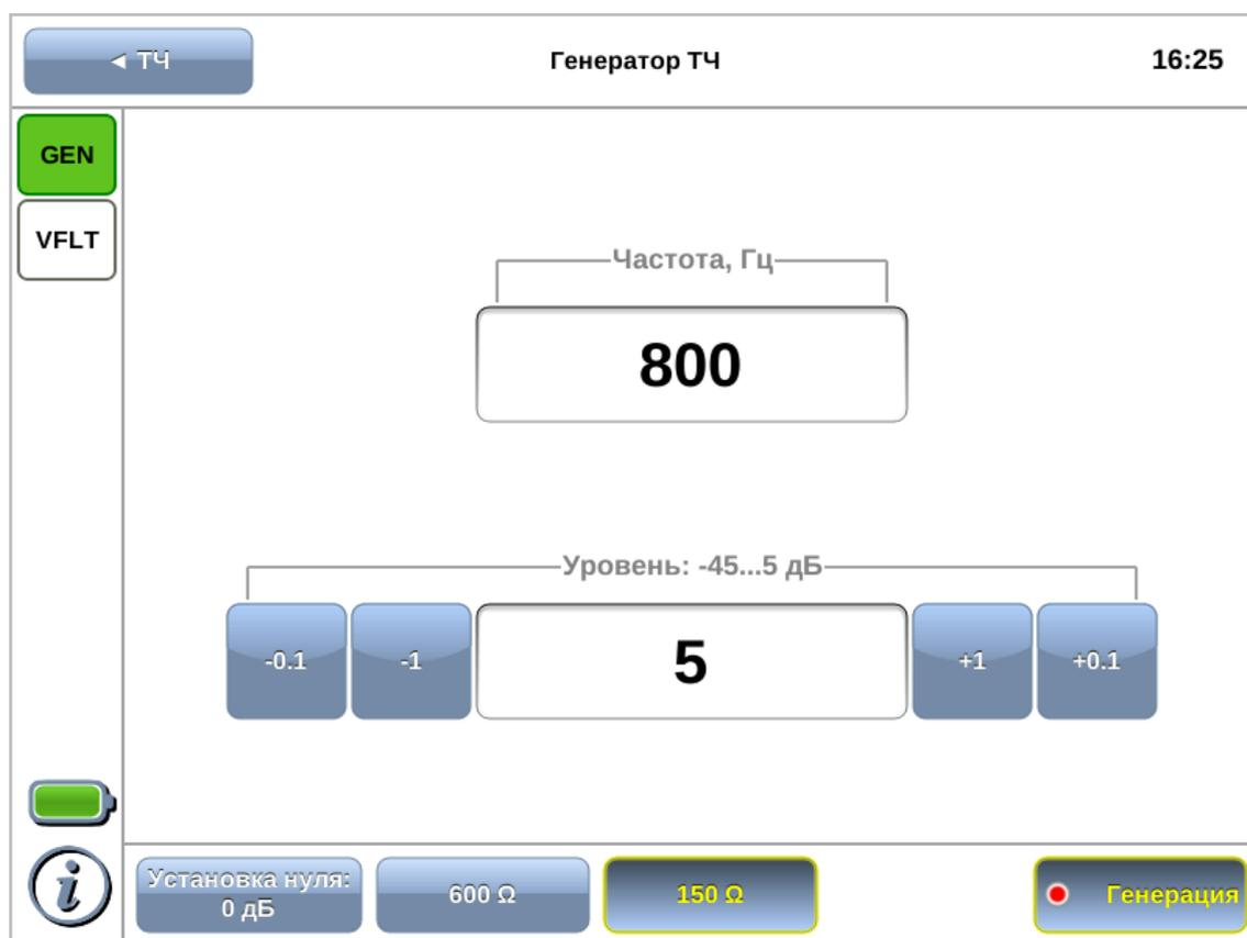
Рисунок 7.1. Режим «Генератор ТЧ»
