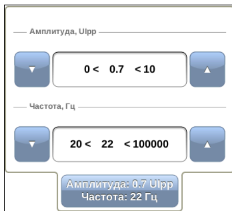
Рис. 11.4. Настройка генератора джиттера
