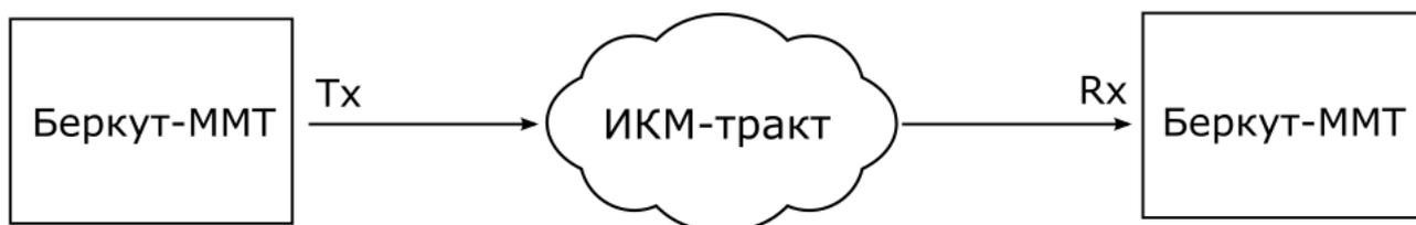
Рисунок 8.2. Схема с выводом канала из обслуживания. Вариант 1
