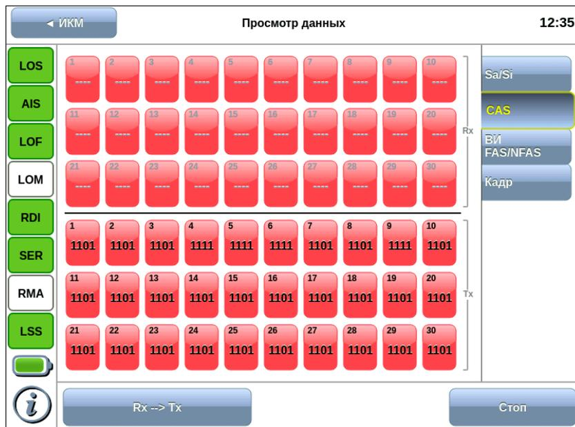
Рисунок 12.3. Вкладка «Сигнальные биты CAS», поток ИКМ31
