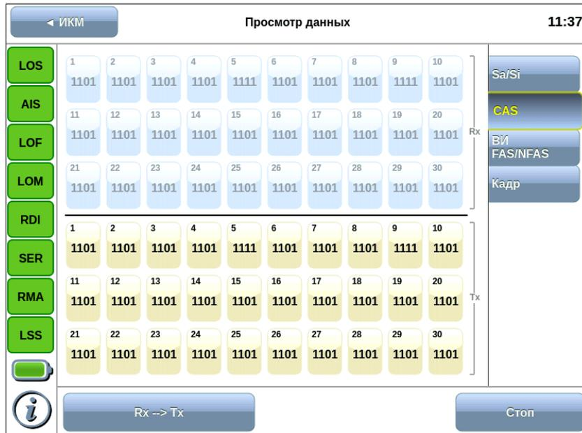
Рисунок 12.2. Вкладка «Сигнальные биты CAS», поток ИКМ30
