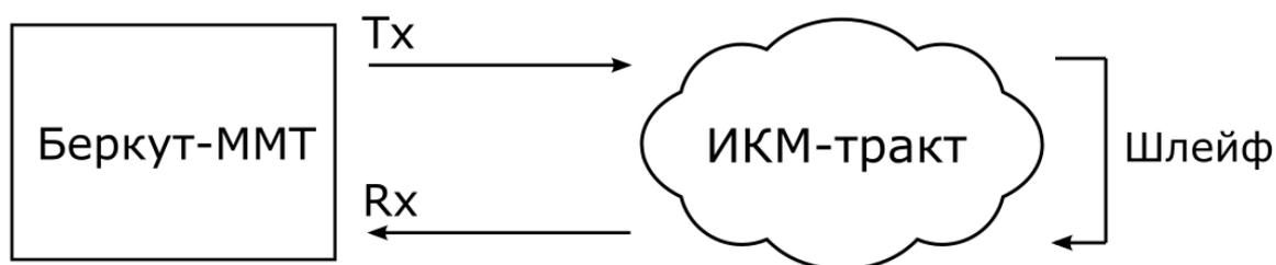
Рисунок 8.3. Схема с выводом канала из обслуживания. Вариант 2
