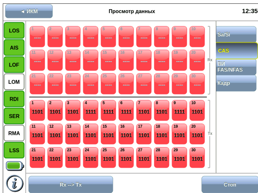
Рисунок 12.3. Вкладка «Сигнальные биты CAS», поток ИКМ31
