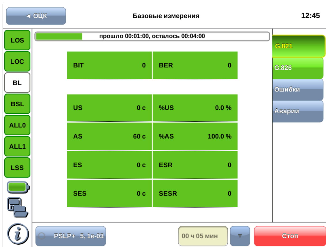
Рисунок 8.4. Результаты измерений G.821
