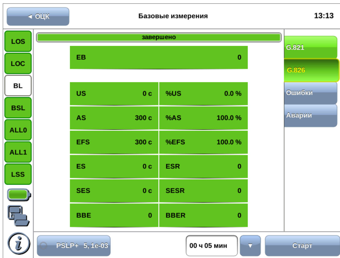
Рисунок 8.5. Результаты измерений G.826
