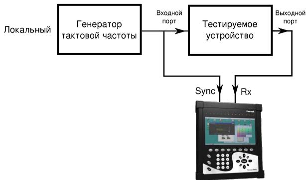
Рис. 7.8. Синхронная схема измерения вандера
