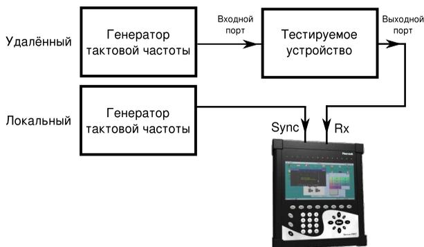
Рис. 7.7. Асинхронная схема измерения вандера
