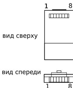
Рис. С.1. Схематическое изображение контактов разъёма RJ-45
