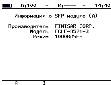
Рис. 7.119. Экран «Информация о SFP-модуле»
