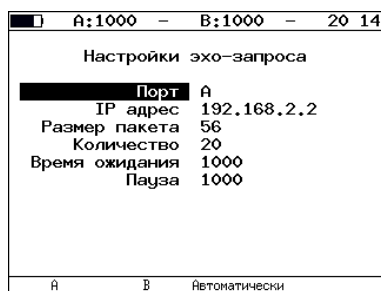
Рис. 7.56. Настройки теста Ping
