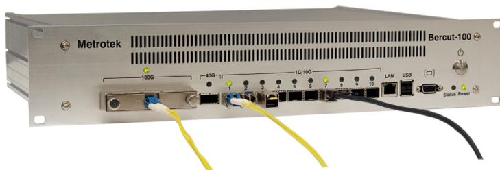
*Рис. 4.1. Лицевая панель прибора Metrotek B100*
