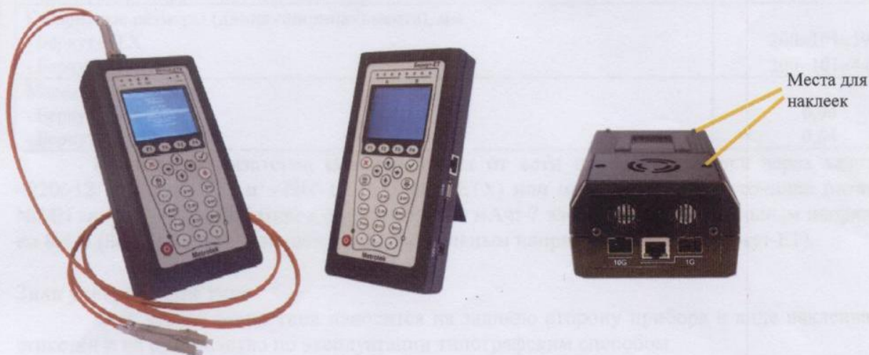
Рисунок 1- Общий вид анализаторов Беркут-ЕТХ и Беркут-ЕТ
