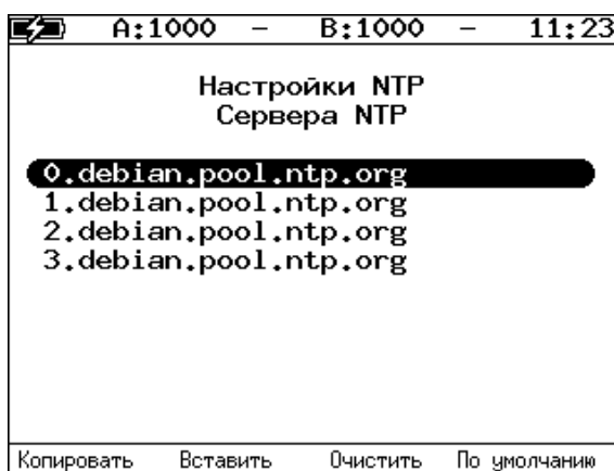
Рисунок 6.18. Настройка параметров синхронизации NTP. Список стандартных серверов
