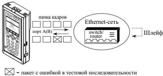
Рис. 7.103. Тестирование на канальном/сетевом уровне (вариант 2)
