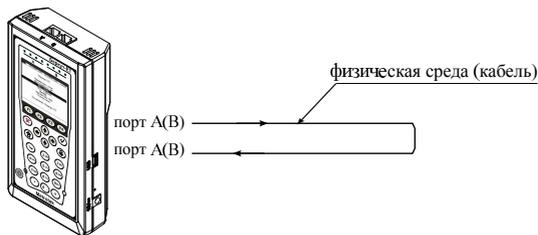
Рис. 7.100. Тестирование на физическом уровне (вариант 1)
