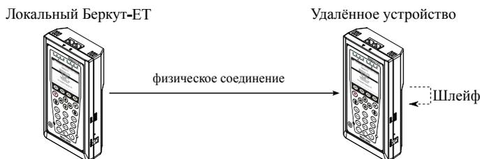
Рис. 7.66. Схема тестирования
