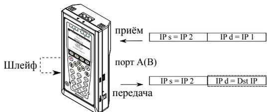
Dst IP - IP-адрес получателя, заданный пользователем.
