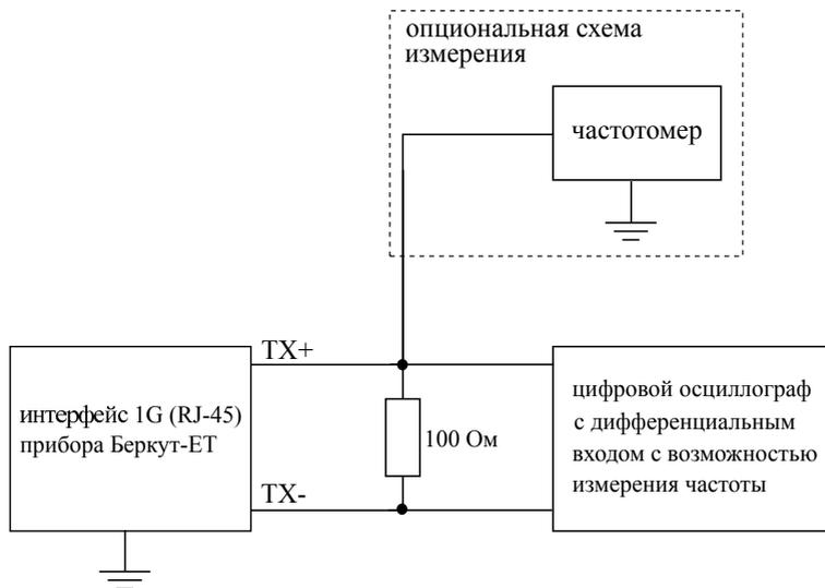
Рис. 10.1. Схема подключения
