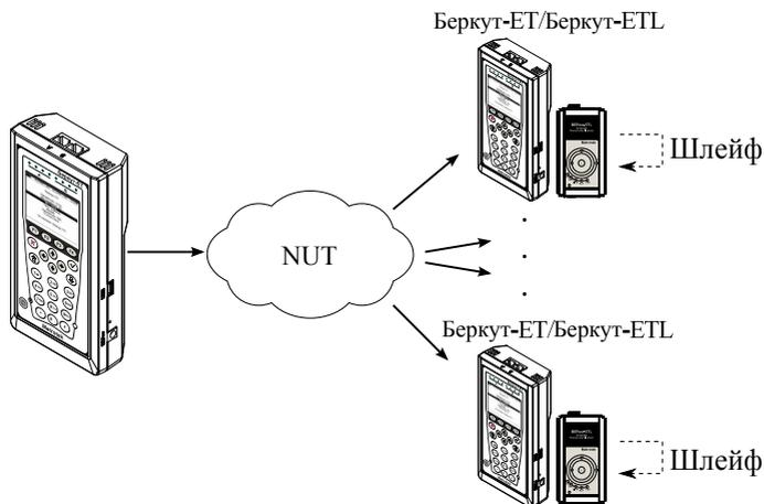
Рис. 7.69. Схема тестирования
