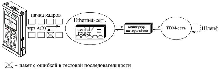
Рис. 7.102. Тестирование на канальном/сетевом уровне (вариант 1)
