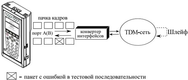
Рис. 7.104. Тестирование на канальном/сетевом уровне (вариант 3)
